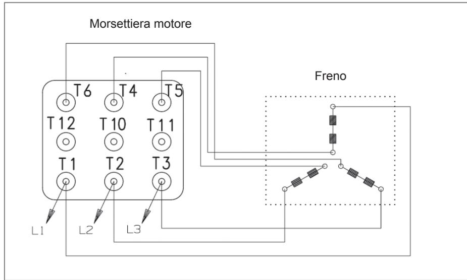
Per i motori a doppia polarità, per i motori a nove perni (BX, BE, BN, MX, ME, M, MNN) e, quando richiesto, per i motori ad una velocità con alimentazione da linea separata è prevista una morsetteria ausiliaria a 6 morsetti per il collegamento del freno; in questa esecuzione i motori prevedono la scatola coprimorsetti maggiorata
