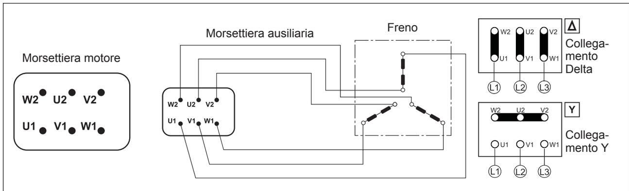
Eeguire il cablaggio del freno concordemente alla tensione e al tipo di collegamento indicati in targa.
